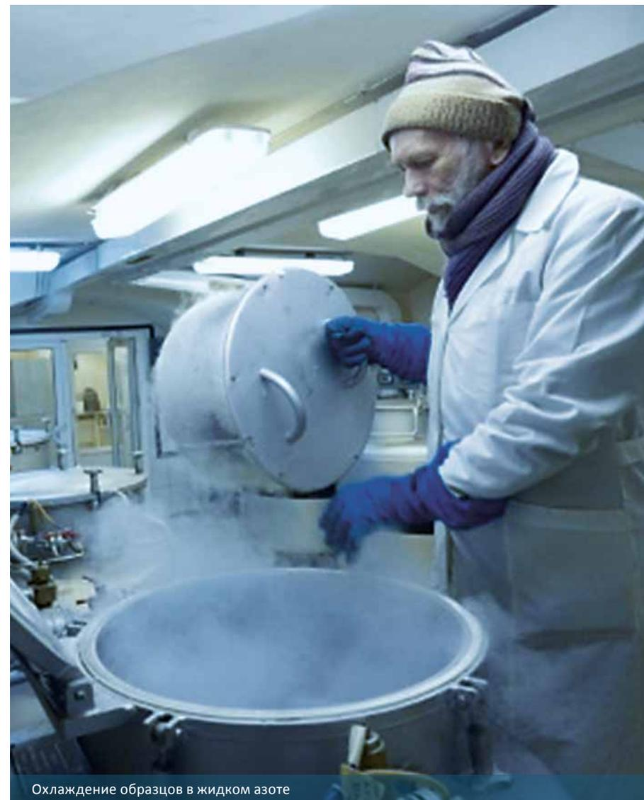
Охлаждение образцов в жидком азоте
